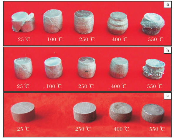
图 4 TC4 网 /Al 复合材料经不同应变率压缩后的宏观照片
