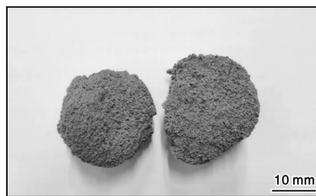
图 1 铝热还原氟钛酸钠法制备的钛铝合金
