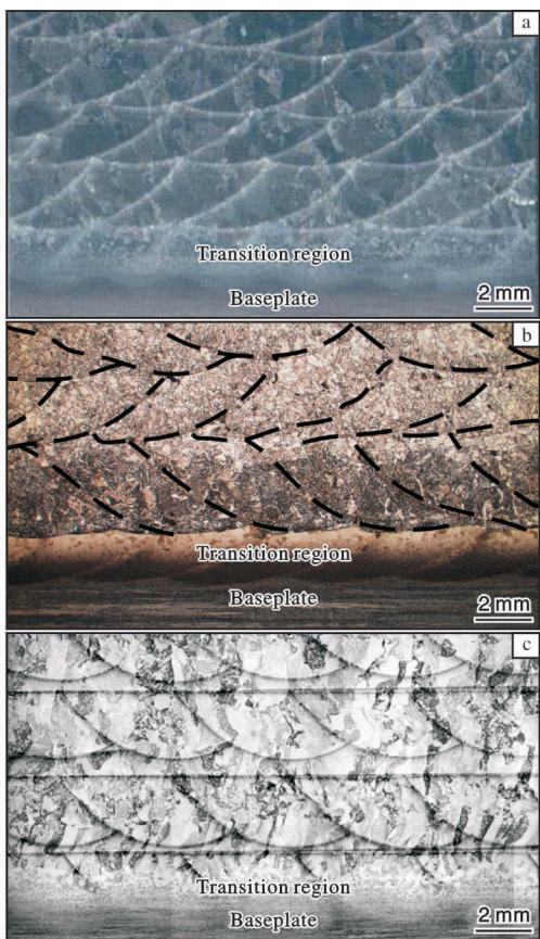
图3 不同增材路径下TA2纯钛试件的焊道熔合形貌
