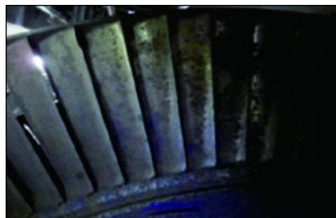
图 4 钛合金叶片被腐蚀后的照片 [28]
