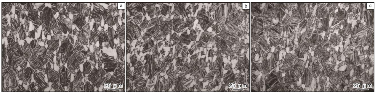
图 8 Ti6321 合金焊接接头在不同应变率下动态压缩后母材区的显微组织
