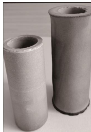
图 8 钛合金熔炼用陶瓷坩埚 [28]
