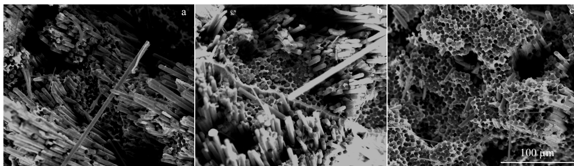
图7 三维五向 C f /Al 复合材料室温拉伸断口形貌
