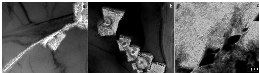
图 4 7055 铝合金 120 和 400 °C 时效不同时间样品在 1 mol/L NaCl+0.032 mol/L H 2 O 2 溶液浸泡 10 s 后的 TEM 明场像
