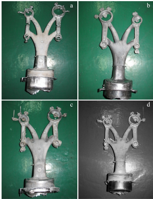
图4 不同浇注温度下半固态挤压铸造连杆的充填状态
