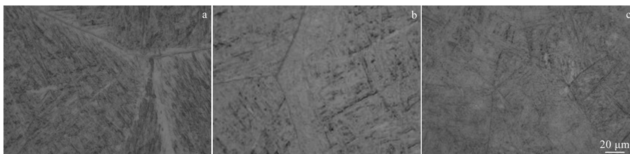
图2 1025 °C 加热后不同冷却速度下 TA15 板材初始组织状态
