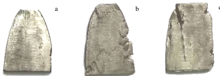
图11 轧制小板试样外观
