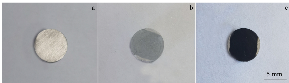
图 2 LAZ141 合金在低温等离子体中处理前后的表面形貌
