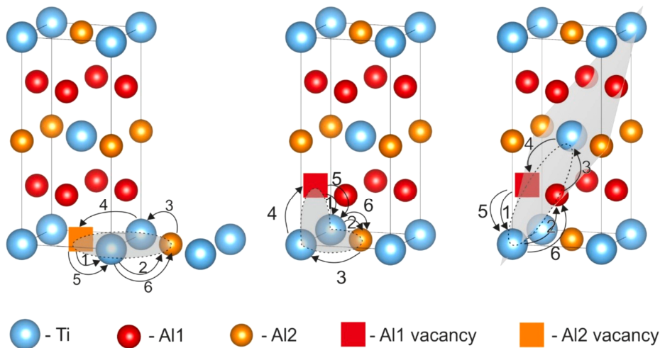
图 6 Ti 原子在 D0_{22} 结构 TiAl_3 相中的几种 6 次跳动空位循环换位机制
