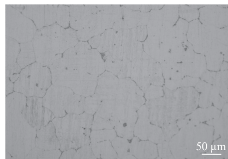
图7 铸态GZ32K合金均匀化的金相显微组织
