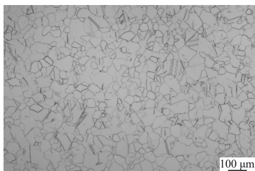
图1 TA16钛合金锻态显微组织
