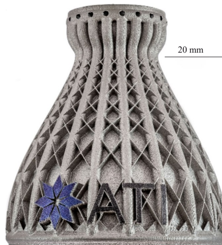
图6 增材制造的集成冷却概念推进器
