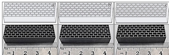
图 1 不同框架厚度的 AlSi10Mg 结构设计图与实物图
