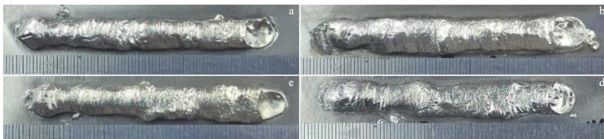
图15 峰值电流350 A、脉冲频率20 Hz时不同占空比下焊缝成形的宏观照片
