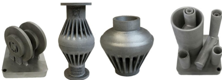
图7 欧洲核子研究中心SLM成型钨合金原型
