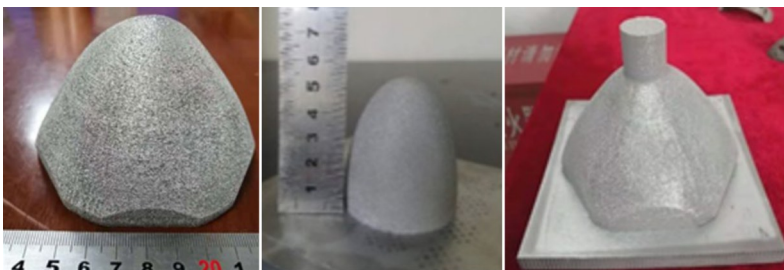
图8 SEBM 纯钨薄壁件
