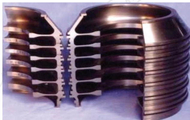
图 18 惯性摩擦焊接的发动机压气机整体转子部件
