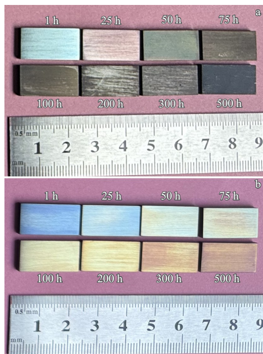
图2 ZTNM钛铝合金不同时长氧化外观形貌
