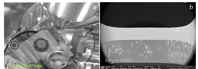
图 3 原位拉伸装置及待测样品
