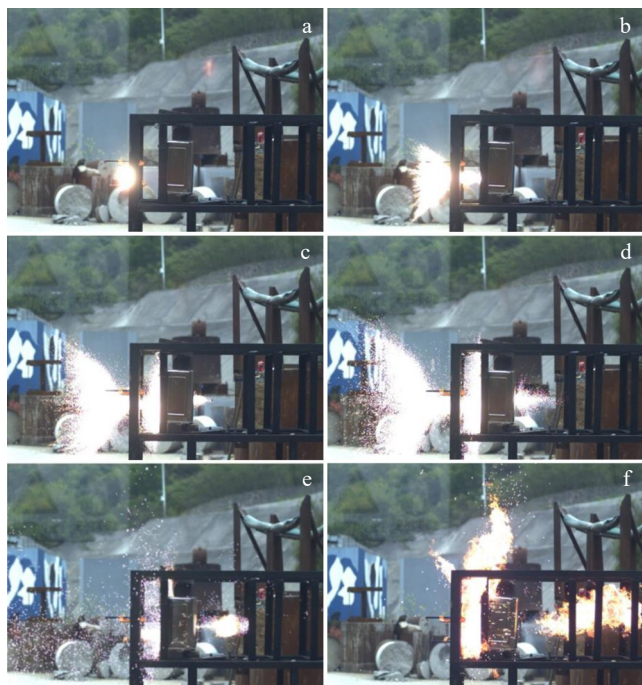
图 10 ZrTiNi 合金引燃航空煤油油箱的高速摄像照片
