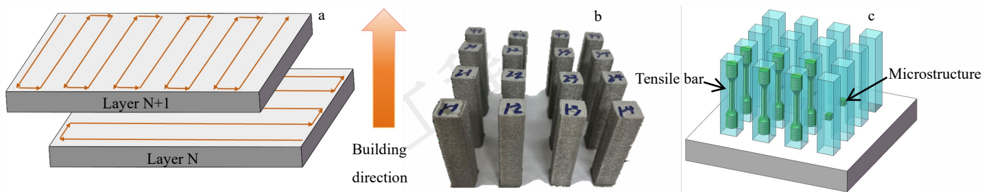
图 2 EB-PBF 成形 TiAl-4822 合金试样扫描路线、样品形貌及取样位置
