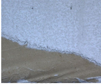
图 12 断口附近的亚结构
