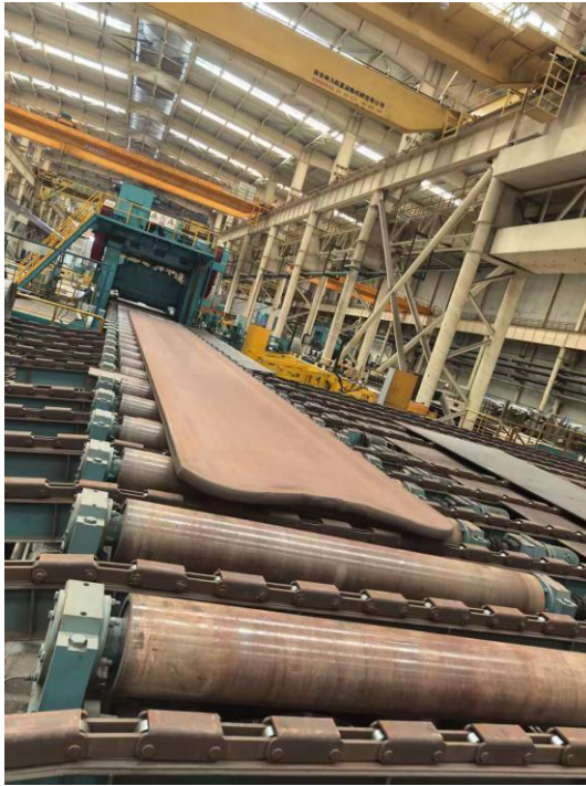
图4 西部钛业有限责任公司生产的大规格 TC4 板材
