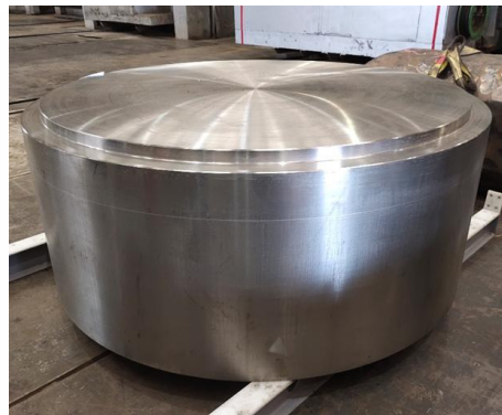
图 6 西部超导公司生产的大规格 Ti75 合金饼坯实物图
