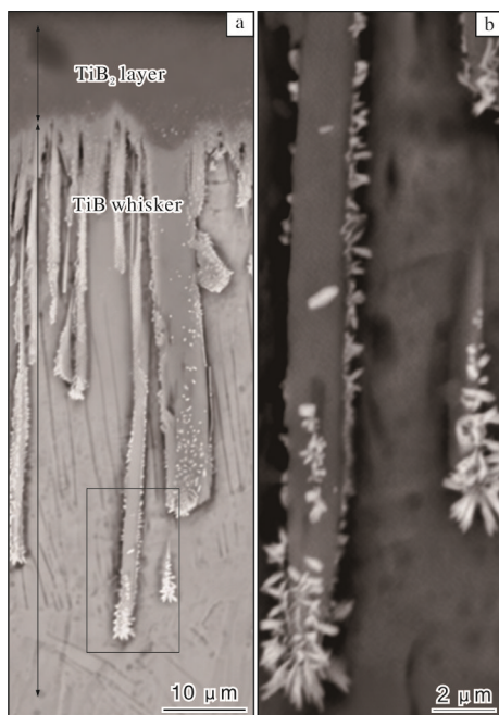
图5 Ti-5Al-2.5Sn 合金表面渗硼层的 SEM 形貌 [23]
