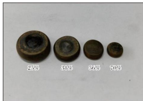
图9 TC4 钛合金丝材热顶锻后的形貌
