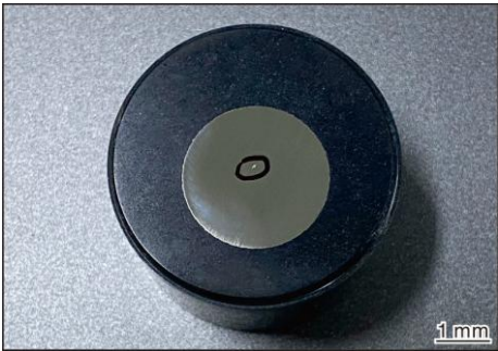
图 7 Gr.5 钛合金棒材缺陷的宏观形貌
